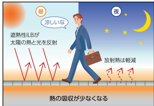
■ 舗装を暖める太陽光を反射し、表面温度を低減します。
