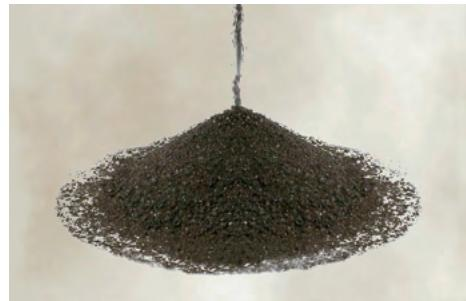
砂粒子の周りがアスファルトでコーティングされていることから、細粒化現象を緩和します。局部沈下やわだち掘れ等の発生を抑制します。
