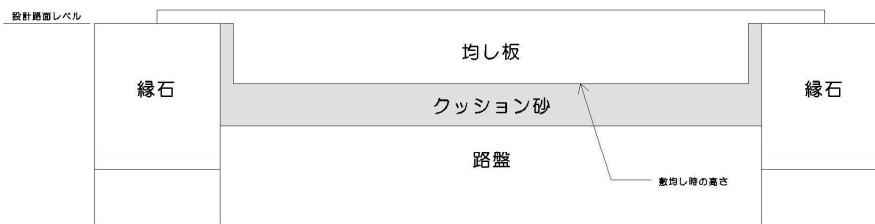
図2 均し板による敷均し
