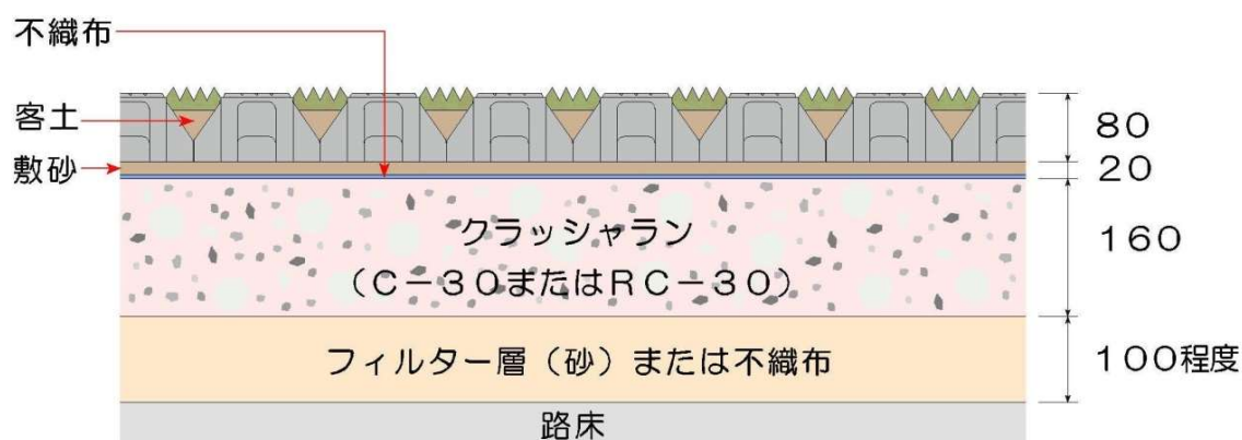
乗用車主体の駐車場の舗装構造の例
