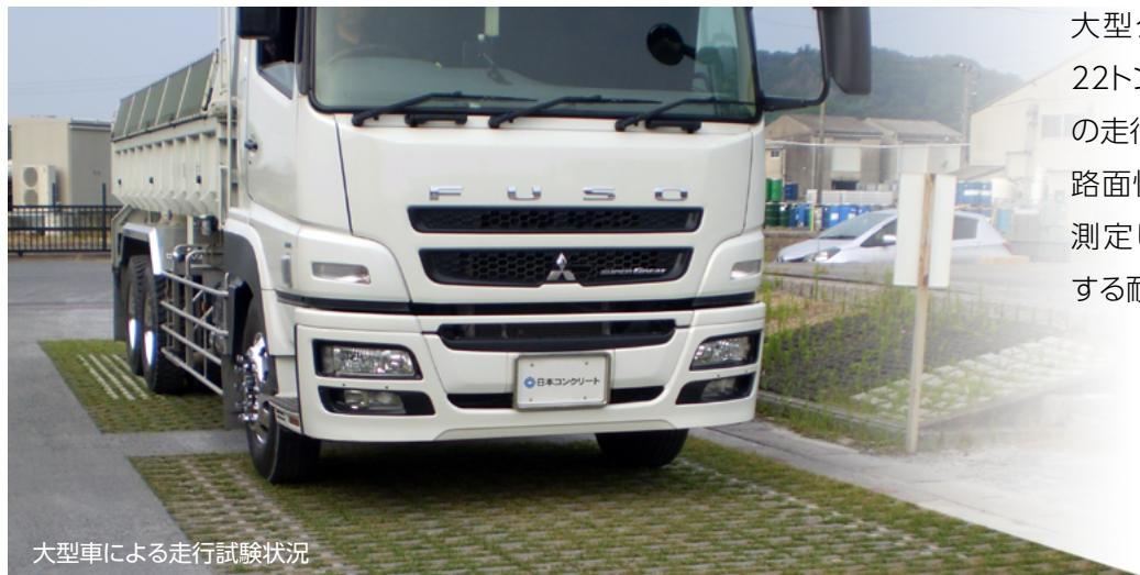
大型ダンプ車(総重量約22トン)にて1,500回以上の走行試験を実施。路面性状と舗装支持力を測定し、大型車走行に対する耐久性を実証。
