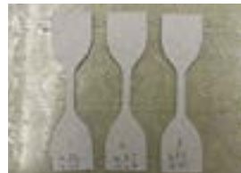
[ダンベル状試験体]
